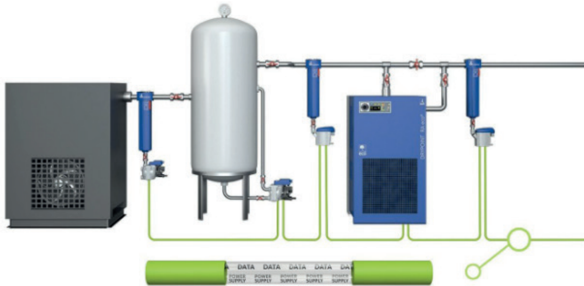
Vernetzung aller BEKOMAT Kondensatableiter per Daisy-Chain Bildmaterial: BEKO TECHNOLOGIES
